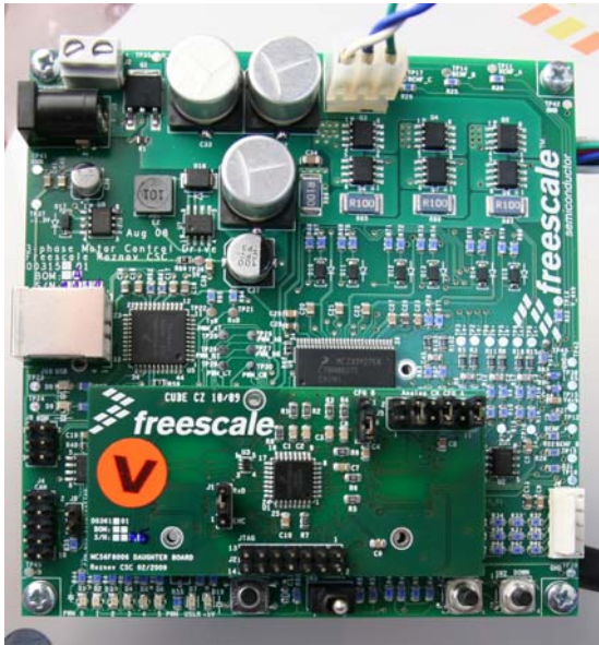
图 4-2. 带子板的 3 相 BLDC/PMSM 低压电机控制驱动板
