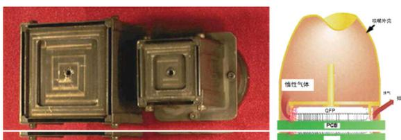
图 17. 典型的 QFP 加热喷嘴示例
