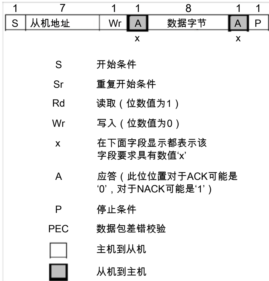
图 3. SMBus 数据包协议图关键的元素
